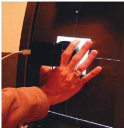
**Figura 24.** Cámara con sujeción manual para análisis cuantitativo en la sala de lectura.
