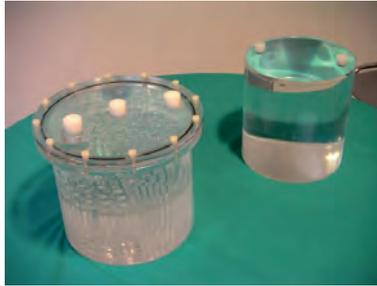
**Figura 20.** Maniqués cilíndricos.
