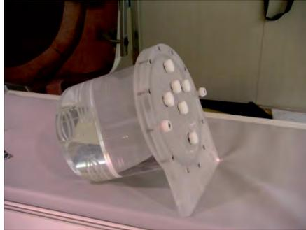
**Figura 26.** Maniquí y sistema de sujeción.
