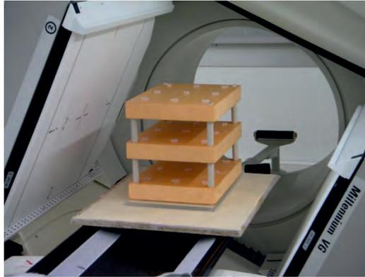
**Figura 30.** Maniquí volumétrico de fuentes mixtas emisoras  $\gamma$  y opacas a RX.
