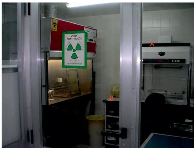
**Figura 3.** Sala de marcaje celular. A: cámaras de flujo laminar. B: esclusa.
