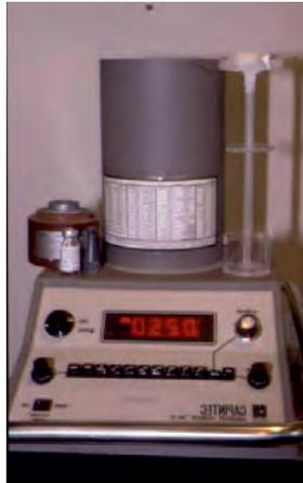
**Figura 5.** Activímetro y fuente calibrada de periodo largo, para prueba de estabilidad.
