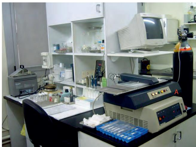
**Figura 9.** Laboratorio caliente para manipulación de muestras y control de calidad. (A: radiocromatógrafo).
