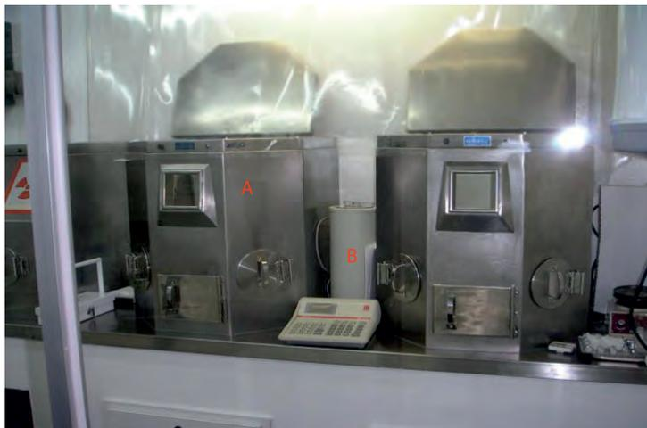
**Figura 2.** Cámara caliente. A: castillos de plomo. B: activímetro.
