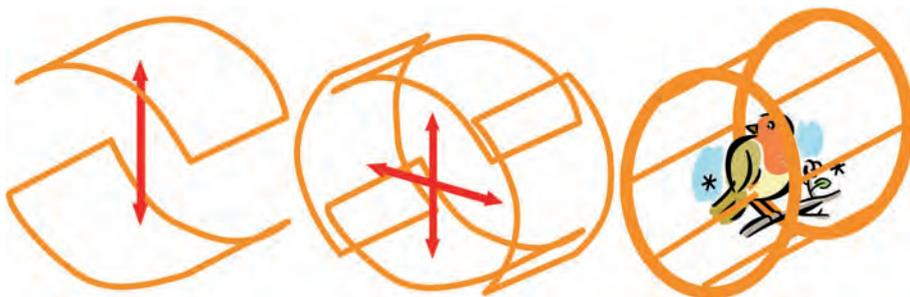
**Figura 9.** Izquierda, configuración de bobina lineal. Centro, configuración de bobina en cuadratura tipo "saddle". Derecha, configuración de bobina en cuadratura tipo jaula de pájaro o "birdcage".
