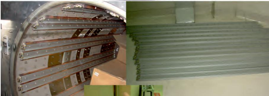
**Figura 6.** Ejemplos de “shimming” pasivo para un equipo de RM abierto y para un equipo de RM cilíndrico. Se pueden apreciar las piezas metálicas que se insertan en el disco o en las guías longitudinales para realizar las correcciones de heterogeneidad.
