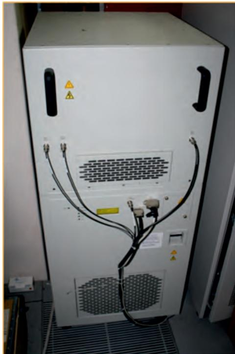
**Figura 5.** Amplificador de RF de un equipo de RM de 3 teslas basado en válvulas de vacío.
