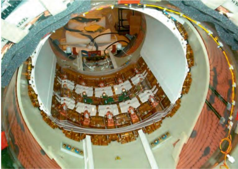
**Figura 10.** Bobina de transmisión de RF o “de cuerpo” insertada dentro del túnel del equipo de RM. Se puede apreciar el formato tipo jaula de pájaro combinada con elementos electrónicos resonadores.
