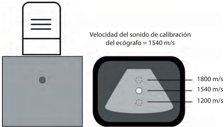
Figura 25. Formación de imagen de un medio en el que la velocidad de propagación corresponde a 1540 m/s, 1200 m/s y 1800 m/s.
