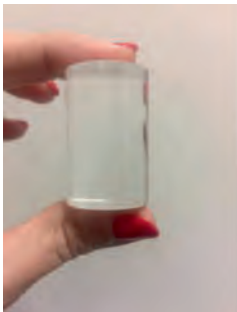
Figura 18. Bloque de plexiglás para la realización de pruebas de la constancia de sensibilidad e imagen obtenida.
