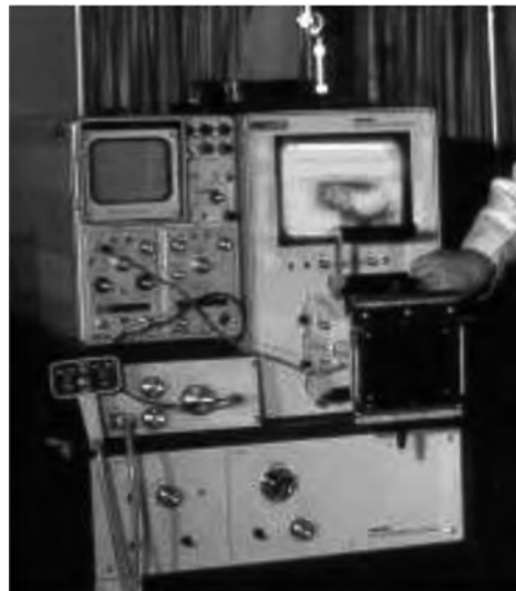
Figura 11. Procesador de señales, "scan converter", con representación de la imagen en modo B en un monitor de TV.
