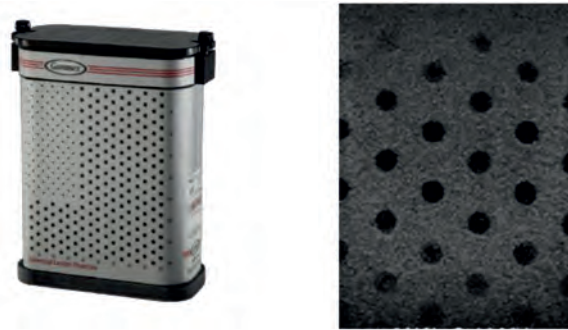
Figura 11. Imagen de un maniquí marca GAMMEX para la realización de controles de calidad de resolución axial, lateral y en elevación, en función de la profundidad.
