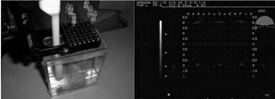
Figura 5. Maniquí para verificar la alineación de la rejilla electrónica y de la plantilla de los aplicadores e imagen obtenida empleando dicho maniquí (Goldstein y cols. 2002).
