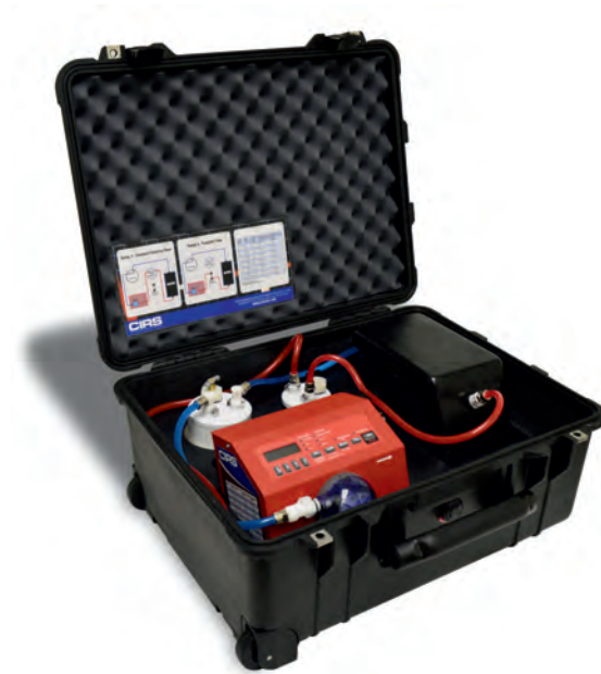
Figura 30. Maniquí marca CIRS de flujo para la verificación de sistemas Doppler.
