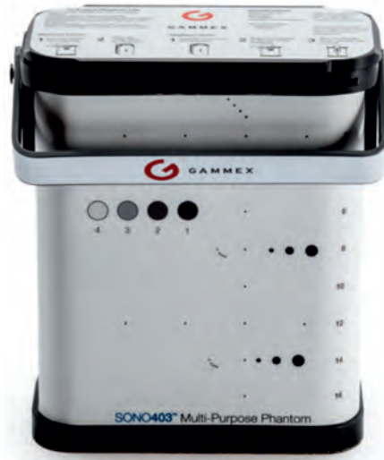
Figura 1. Maniquí con material de base hidrogel, marca GAMMEX.
