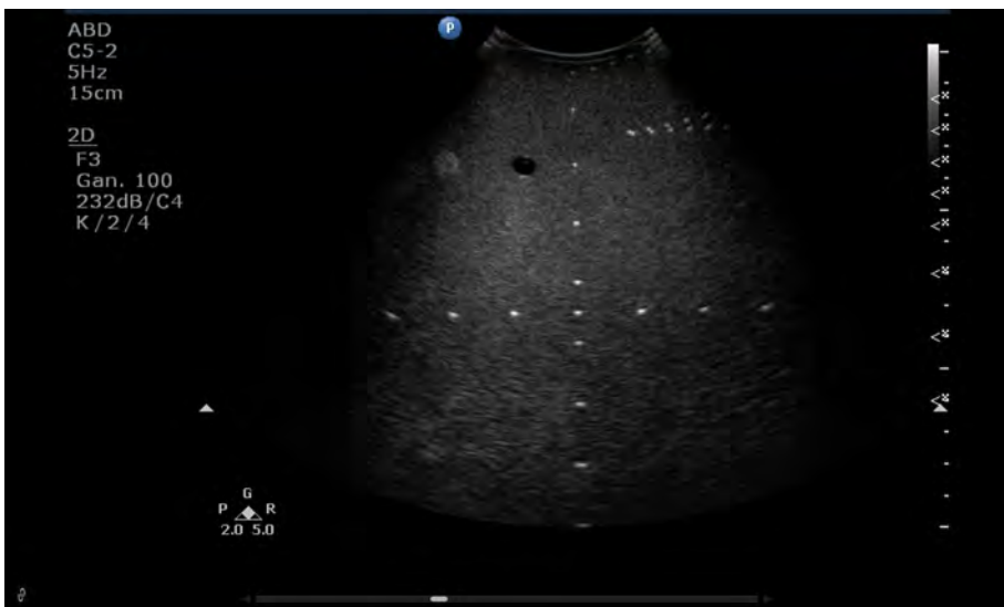
Figura 2. Maniquí con reflectores puntuales en los que se puede apreciar el efecto de la anchura del haz.
