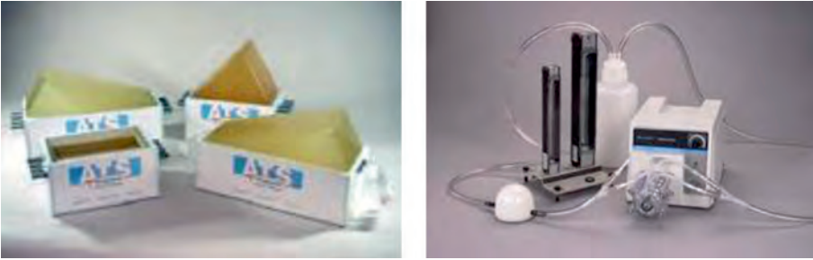
Figura 29. Maniquí marca GAMMEX de flujo para la verificación de sistemas Doppler.
