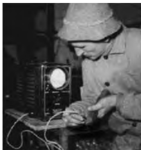
Figura 2. Detectores usados en la detección de inhomogeneidades en metales.
