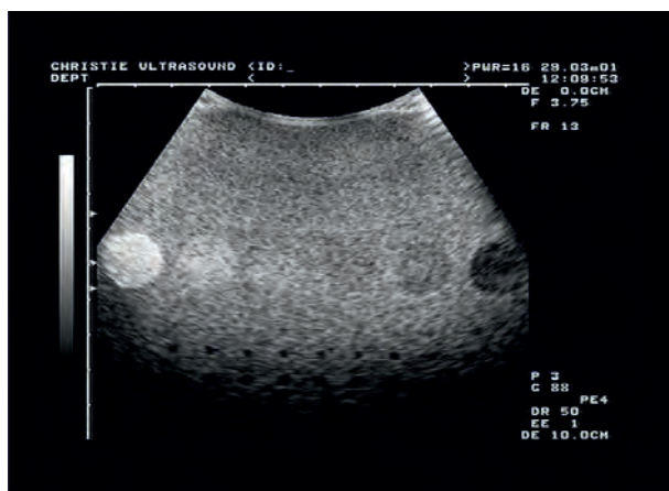
Figura 24. Imagen de maniquí con esferas de distintas ecogenicidades para el control de calidad de umbral a bajo contraste.
