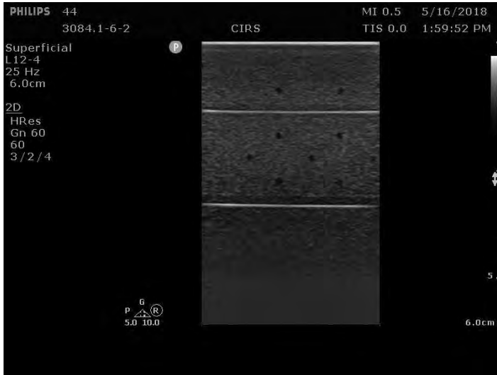
Figura 5. Maniquí de estructuras anecoicas donde se visualiza el efecto de la anchura de corte (cortesía de CIRS).
