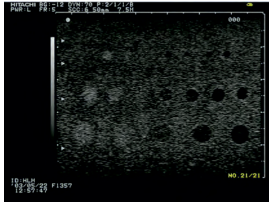
Figura 25. Imagen de maniquí con esferas de distintas ecogenicidades y tamaño para el control de calidad de umbral a bajo contraste.
