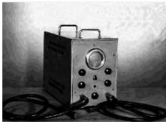
Figura 5. Detector de inhomogeneidades en metales empleado como ecógrafo modo A.
