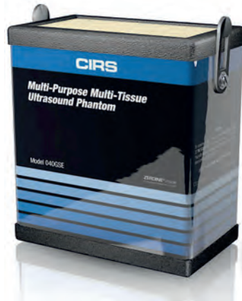
Figura 3. Maniquí con material de base Zerdine™, marca CIRS.
