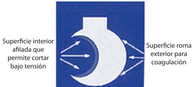
Figura 1. Esquema del borde de la cuchilla vibrante; el resultado final es el corte y la coagulación simultáneos.
