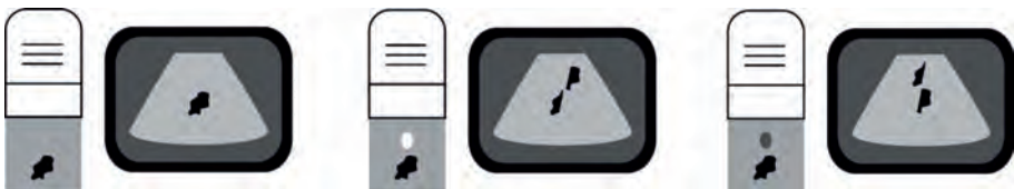
Figura 26. Imagen formada en el caso de un haz de Ultrasonidos que atraviesa estructuras con distintas velocidades de propagación, que cubren parcialmente objetos que son representados en la imagen.
