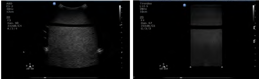
Figura 6. Imágenes de maniquí con un cilindro anecoico obtenidas respectivamente con un transductor convexo a 3 MHz y con un transductor lineal a 7 MHz.
