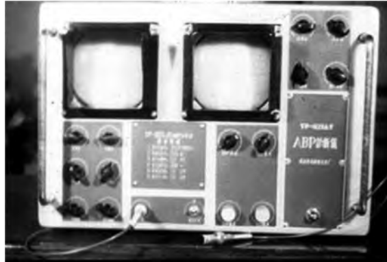
Figura 6. Ecógrafo primigenio en modo B basado en el uso de osciloscopios.
